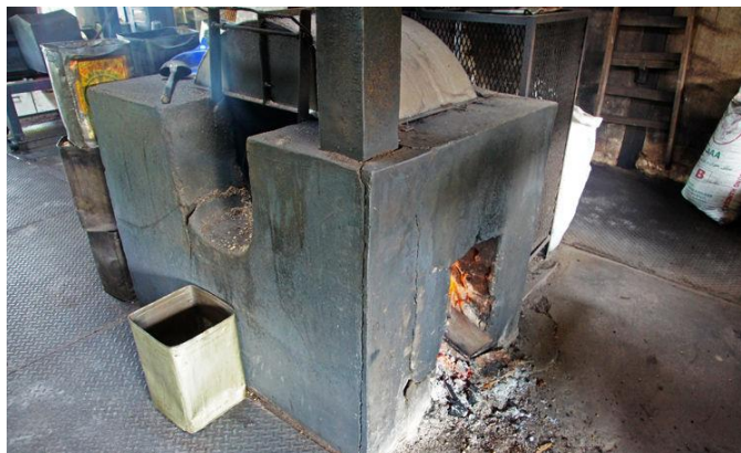
Gambar 9 Ketuhar pemanggang biji kopi menggunakan kaedah pembakaran kayu api
