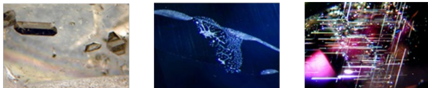
Rajah 2 Antara Jenis-Jenis Inklusi Terdapat Dalam Batu Permata. Dari kiri crystal inclusion , fingerprint inclusion dan needle inclusion . Sumber Gambar: Gem Identification, AIGS (2006).
