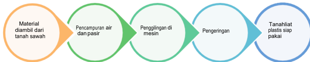
Diagram 2: Teknik produksi tanah liat secara modern (Sumber : Peneliti, 2018)
